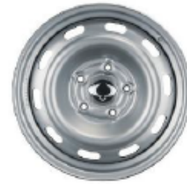
Cerchi da 17" in acciaio con pneumatici 235/70 R17
